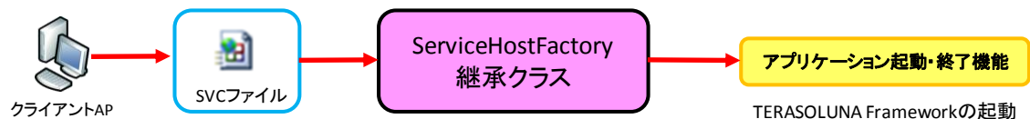
図 2 サーバ AP における TERASOLUNA フレームワークの起動
